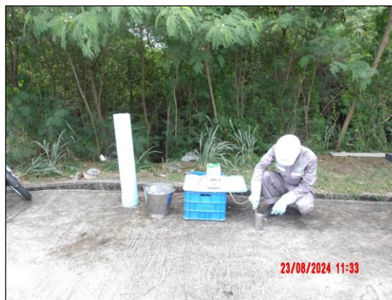
รูปที่ 3.16 การเก็บตัวอย่างคุณภาพน้ำใต้ดิน บริเวณพื้นที่นิคมฯ ปิ่นทอง โครงการ 3 (GW5)
