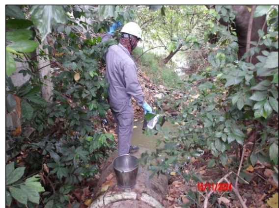
รูปที่ 3.11 การเก็บตัวอย่างคุณภาพน้ำผิวดิน บริเวณห้วยหนองปรือหลังจุดระบายน้ำทิ้งของโครงการประมาณ 500 เมตร (SW3)
