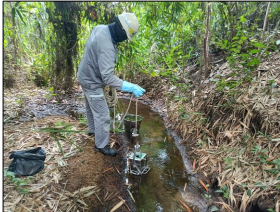
รูปที่ 3.22 การเก็บตัวอย่างโลหะหนักในตะกอนดิน บริเวณท้ายหนองปรือก่อนจุดระบายน้ำทิ้งของโครงการประมาณ 500 เมตร (SD1)
