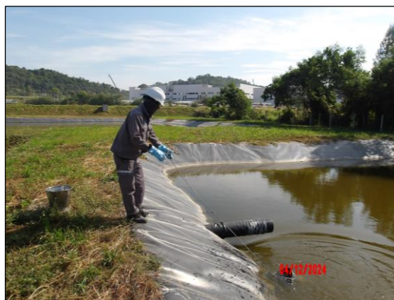
รูปที่ 3.8 การเก็บตัวอย่างคุณภาพน้ำเสีย บริเวณ Holding Pond
