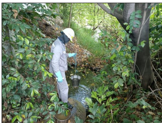
รูปที่ 3.11 การเก็บตัวอย่างคุณภาพน้ำผิวดิน บริเวณห้วยหนองปรือหลังจุดระบายน้ำทิ้งของโครงการประมาณ 500 เมตร (SW3)
